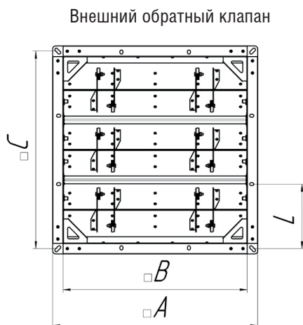
Габаритные размеры и масса обратных гравитационных клапанов для стаканов высотой 1000 мм и 650 мм
