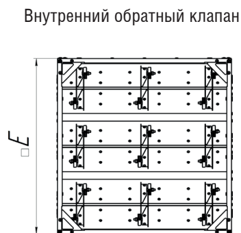
Габаритные размеры и масса обратных гравитационных клапанов для стаканов высотой 1000 мм и 650 мм
